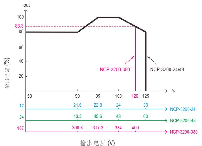
◎ 额定电流随输出电压调整变化
