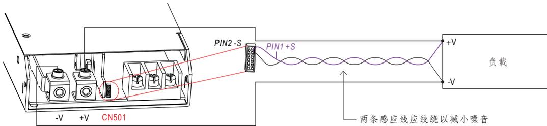
◎ +S 信号应连接负载的正极, -S 信号应连接负载的负极
